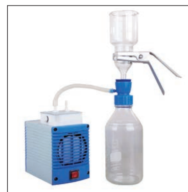
Unità filtrante in vetro con pompa da vuoto anticorrosione
