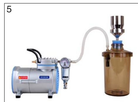
Pompa con recipiente di raccolta e filtro inseriti tramite tappo
