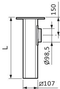
Attacco a soffitto, per montaggio attraverso controsoffitti. La piastra di fissaggio è regolabile per tutta la lunghezza del profilo in alluminio. Se necessario, il profilo di alluminio può essere tagliato durante il montaggio.
