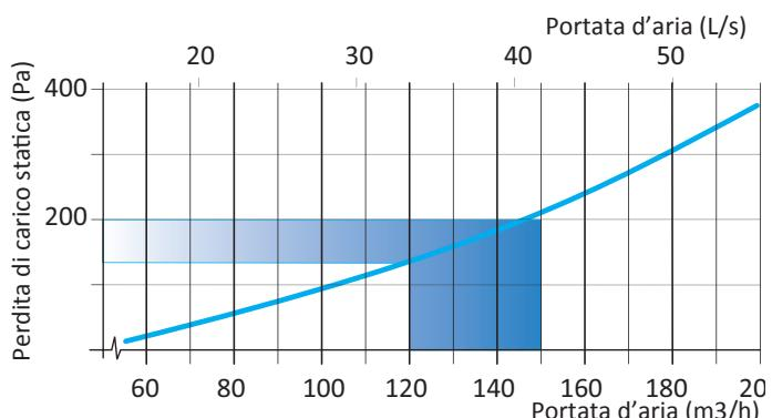
La perdita di carico statica viene misurata in base alla norma ISO 5167-1.
