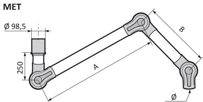
MET per montaggio a soffitto, escluso l'attacco a soffitto MTI.
