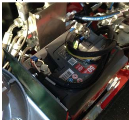
29. Batteria di avviamento motore a scoppio
