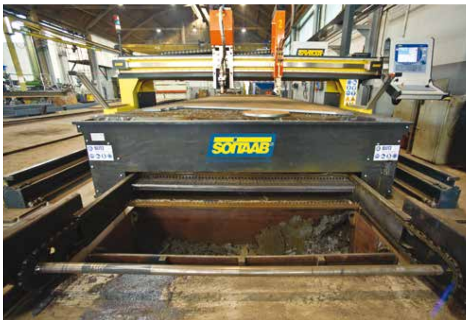
Banco con raschiatore • Scrap conveyor
