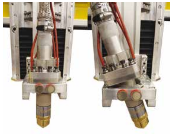
Anticollisione magnetica • Magnetic torch break away
