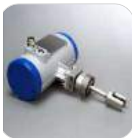
40-14 Immersione 118 mm Flangiato GF50 (filetto G 2 1/4") PN 10, T op < 120°C Atex Zona 2
