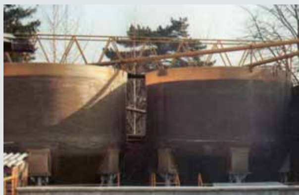
Decantatore con telaio zincato per reflui di lavorazione, capacità 54 m³. Sedimentator-decanter used for machining reflows, capacity 54 m³. Dekanter mit verzinktem Rahmen, für Verarbeitungsrückführung, Kapazität 54 m³.
