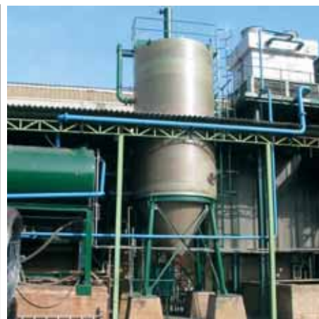
Decantatore Lamellare con telaio zincato per acque da galvanica, capacità 26 m³. Laminar decanter with galvanized structure used for galvanic waters, capacity 26 m³. Lamellarer Dekanter mit verzinktem Rahmen, angewandt für galvanisches Wasser - Kapazität 26 m³.
