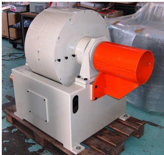
Figura 1.3: Freno a correnti parassite Apicom.
