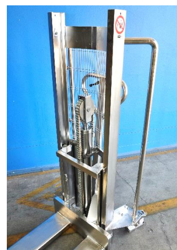
Montante di sollevamento con profili "C" INOX
