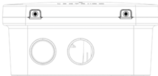
Fig. 11 Viti di fissaggio della cover frontale
