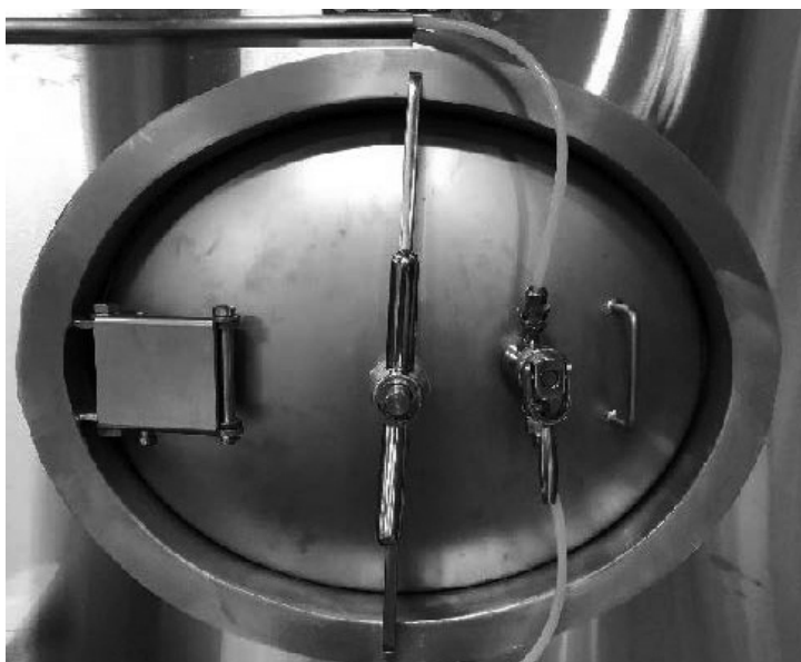
Estrattore di campione di latte semplice: montato sul chiusino o botola.
