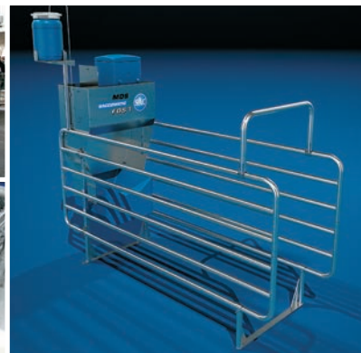
Box di alimentazione fornisce fino a quattro tipi di alimenti - uno dei quali può essere propilene glicolico.
