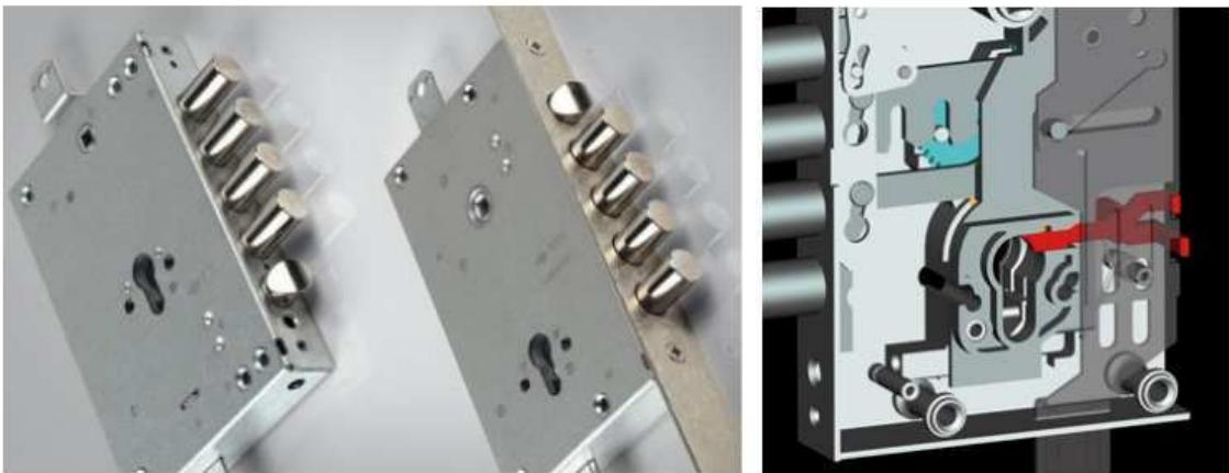
**Sicurezza:** meccanismo a doppia gorge vincolata, 3 mantonnet, sistema di anti-sollevamento della gorge, piastra interna con spine anti-trapano, saracinesca per blocco serratura, porta cilindro anti-sfilamento, blocco del quadro maniglia in posizione di chiuso. Fori di fissaggio protezione cilindro M6 o M8.
