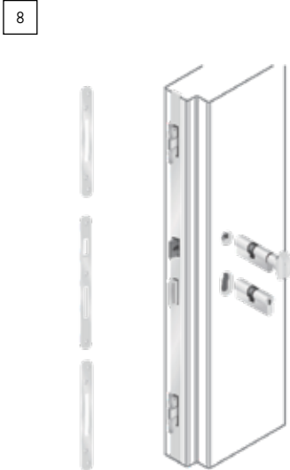
SERRATURA TRIPLICE CHIUSURA PER FILOMURO TRIPLE CLOSURE LOCK FOR FILOMURO
