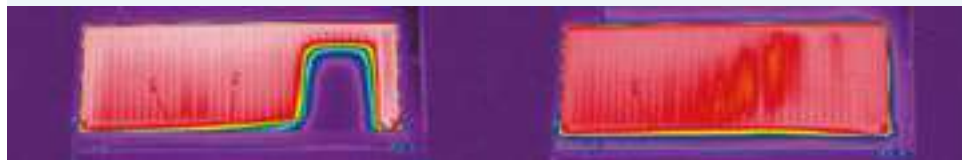
PRIMA: Zona fredda per presenza di fanghi
