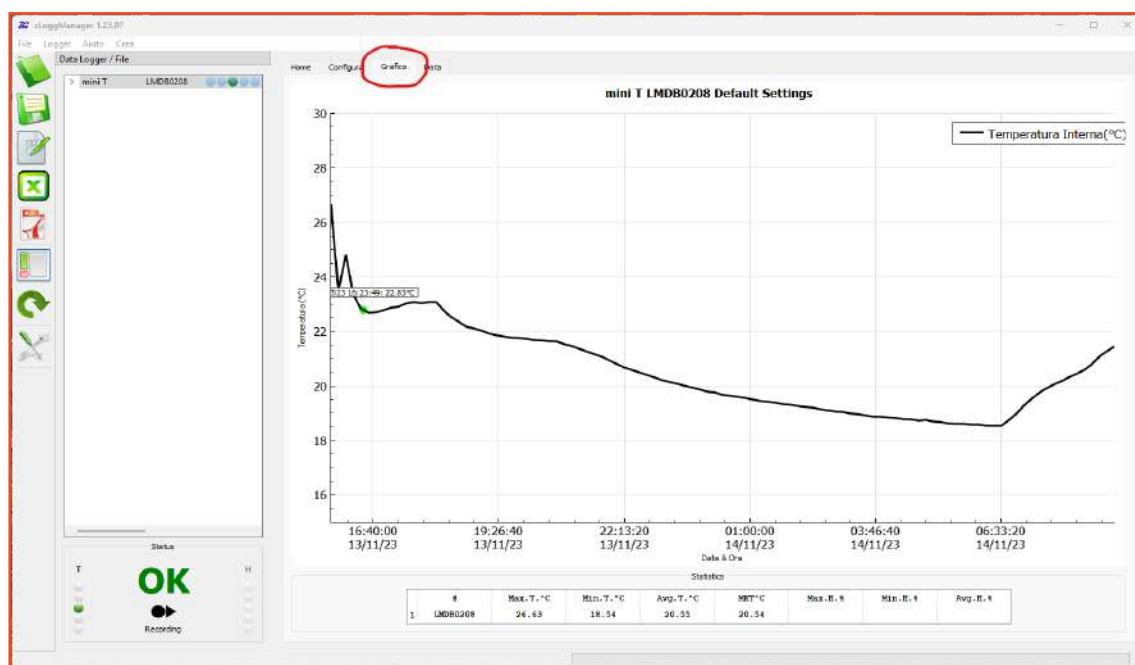
Figura 2: Visualizzatore del grafico avanzato con zoom su entrambi gli assi o sul singolo asse
