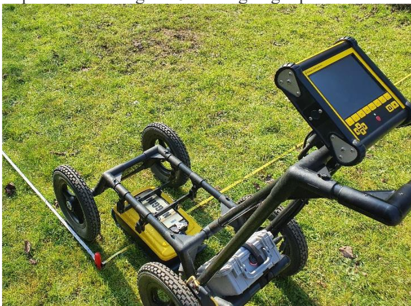
Figura 7: Immagine a solo scopo illustrativo della strumentazione georadar usata per questa indagine.
