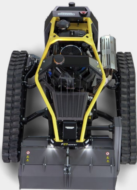
Sistema brevettato di allargamento carreggiata cingoli con variazione del baricentro della macchina. Patented track widening system with variation of the machine's center of gravity.
