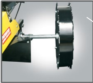
Allargamento carreggiata per una maggiore stabilità in pendenza - Track expansion to increase stability on slopes
