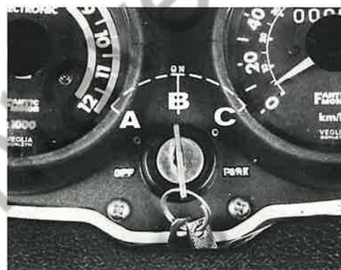
Fig. 6 - Chiave di accensione A - Posizione inserimento chiave B - Contatto accensione C - Accensione luci di posizione ed illuminazione cruscotto.
