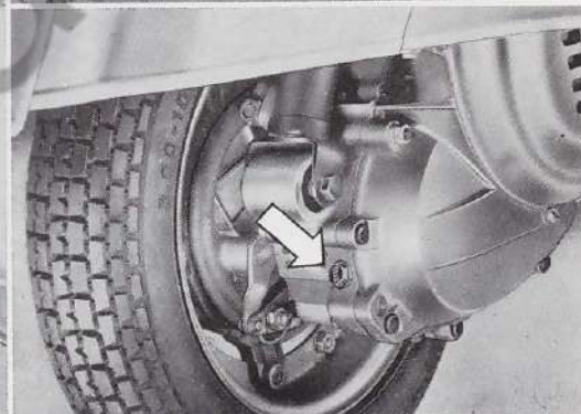
Fig. 10 - Foro di scarico « A » e carico « B » dell'olio del motore.
