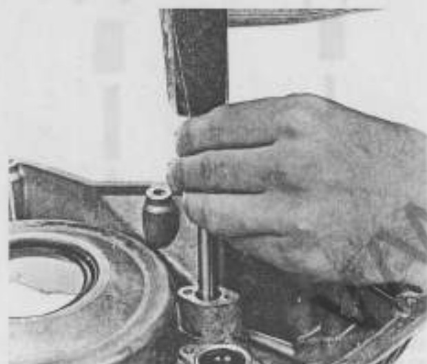
Fig. 91 Assistamento della sfera nella sede Seating the valve steel ball
