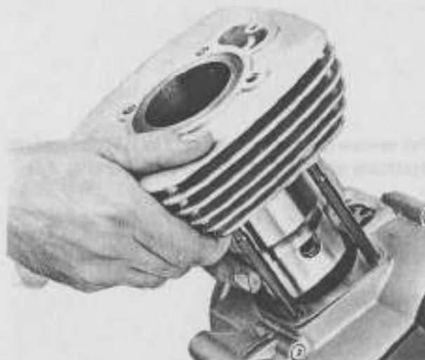
Fig. 44 Rimozione del cilindro Cylinder removal
