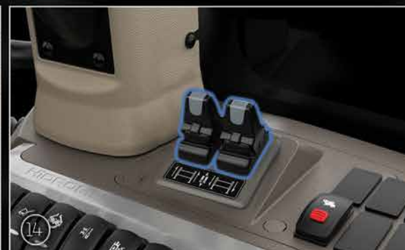
Controllo proporzionale degli stabilizzatori (**)
