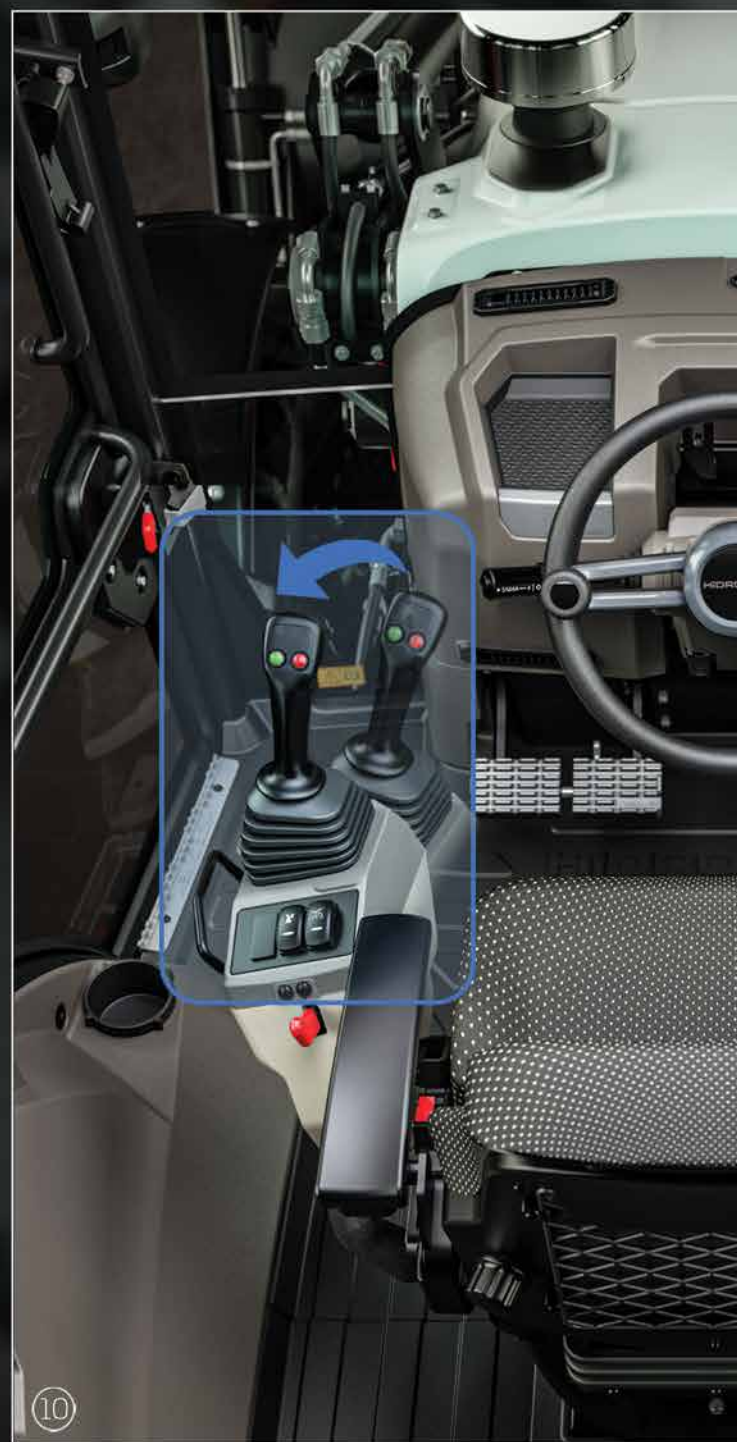
Inclinazione di una certa misura del joystick sinistro affinché l'operatore possa lavorare più comodamente su
