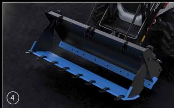
Benna caricatrice anteriore più resistente rinforzata con Hardox
