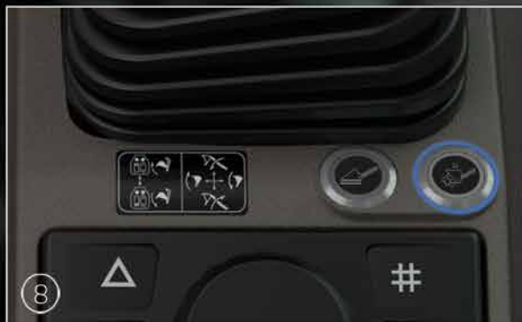
Funzione Ripristino scavo (Return-to-dig)
