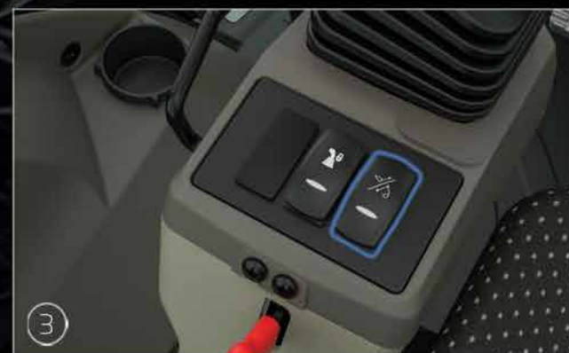
Pulsante del cambio per le funzioni terna o caricatore
